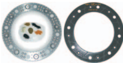
Bild 8 Aufbau des Belags LuK RCF-1 mit Stahlträger
