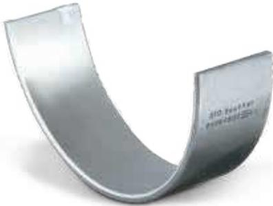
Magnetronschichten zeichnen sich durch feinste Verteilung der einzelnen Gefügebestandteile aus. Ausgangsbasis ist das bekannte Dreistofflager. Der Grundaufbau wurde beibehalten. Die galvanische Gleitschicht wird durch eine gesputterte Gleitschicht ersetzt.
