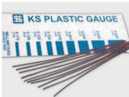
„KS Plastic Gauge“-Messstreifen für Gleitlager (Artikel-Nr. 50 009 880)
