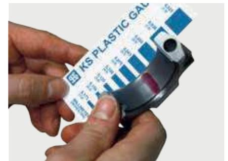
Prüfung des Gleitlagers mit „KS Plastic Gauge“
