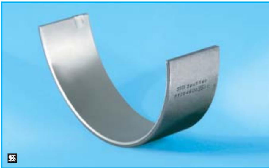
Gesputterte Lagerschalen kommen an den am höchsten beanspruchten Stellen im Motor zum Einsatz. Die Gegenschalen sind bewährte Dreistofflager. Beim Pleuellager wird das Sputterlager meist stangenseitig (oben) eingesetzt. Beim Hauptlager ist die untere Hälfte gesputtert. Die richtige Einbaulage der gesputterten Lagerschale ist Voraussetzung für die Betriebssicherheit. Hierzu ist die Pfeilrichtung in Spalte 1 im Produktprogramm des Kataloges unbedingt zu beachten.
