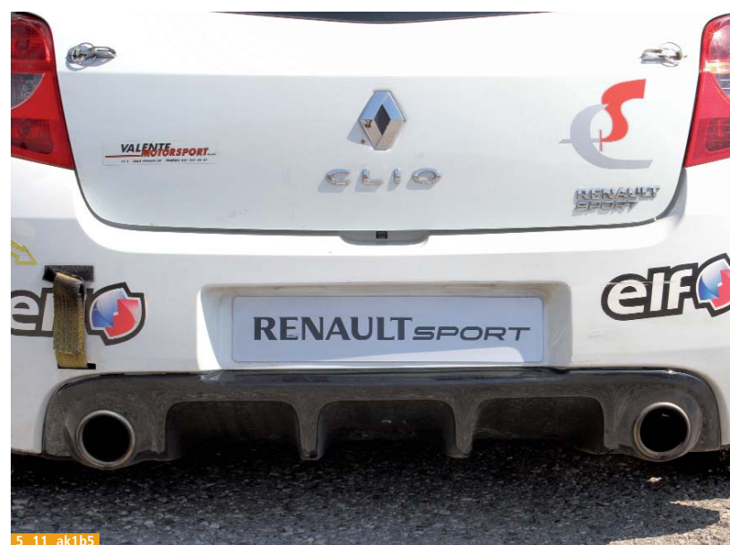
Bild 5. Diffusor, dessen Wirkung – vorab aufgrund der erreichbaren Höchstgeschwindigkeit – wohl eher mässig ist.
