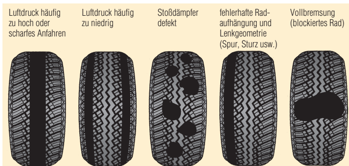
Bild 23.21 Ursachen ungleichmäßigen Reifenabriebs.
