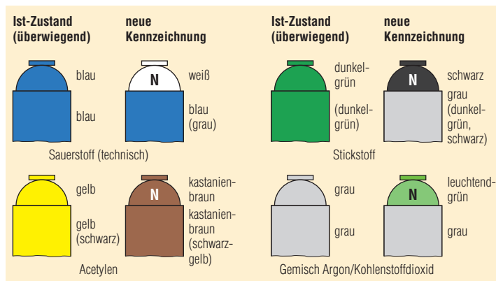
Bild 2.50 Gasflaschen und ihre Kennzeichnung.
