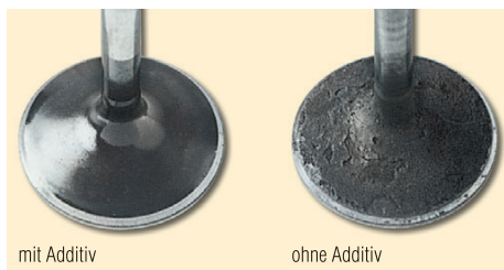
Bild 9.3 Ablagerungen am Einlassventil.
