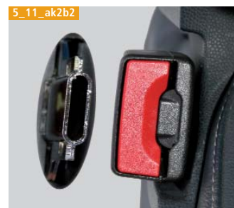
Bild 2. Gurtzunge und Gurtschloss sind speziell aufeinander abgestimmt, damit das Gas in den Gurtairbag strömen kann.
