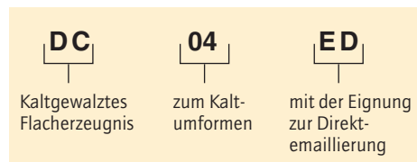
Bild 2.11 Bezeichnungssystem für Stähle nach DIN EN 10027 (Beispiel).
