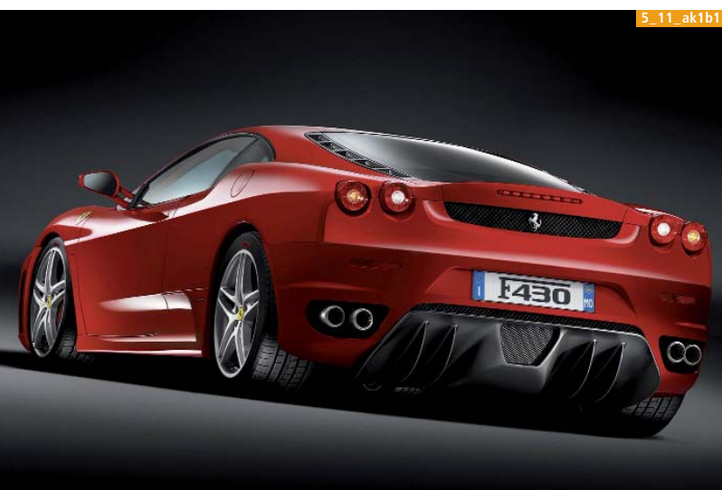
Bild 1. Am Heck des Ferrari F430 sticht der ausgeprägte Diffusor mit den senkrechten Leitelementen ins Auge. (Bild Ferrari)
